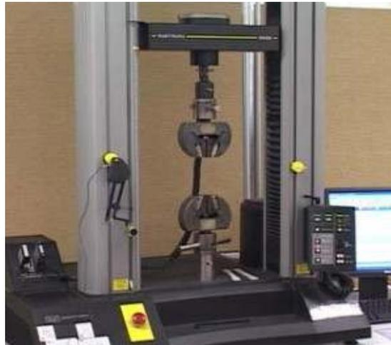
Gambar 35 Mesin Uji Tarik
