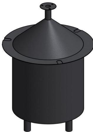
Gambar 13. Desain reaktor pirolisis
