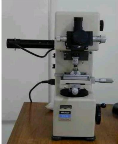
Gambar 12. alat uji kekerasan Vickers. (sumber : Tarwijayanto, 2013)
