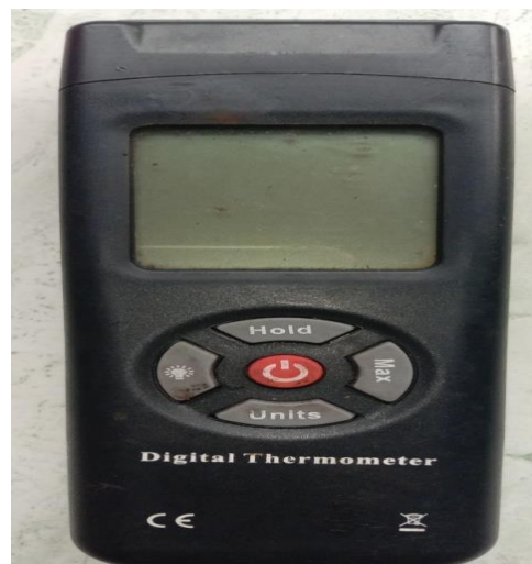
Gambar 13. Alat pengukur suhu ( Thermocouple ) (Sumber : Data lapangan, 2021)
