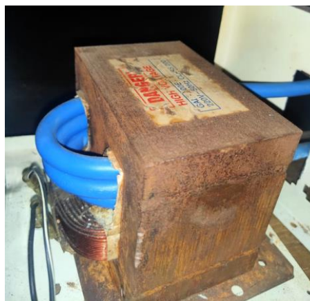
Gambar 47. Trafo Modifikasi 330:3 (Sumber : Data Pribadi)
