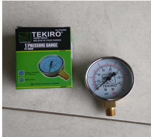
Gambar 21: Pressure gauge Sumber :Dokumentasi Pribadi
