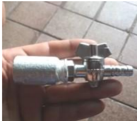
Gambar 19: Kran Gas Sumber : Dokumentasi Pribadi
