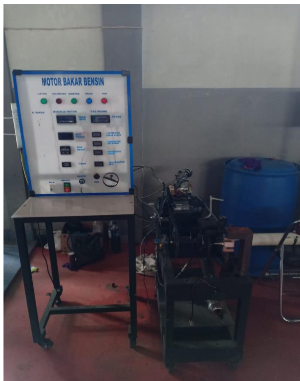
Gambar 15: Alat uji Motor Bakar Bensin sistem dual fuel Sumber : Dokumentasi Pribadi
