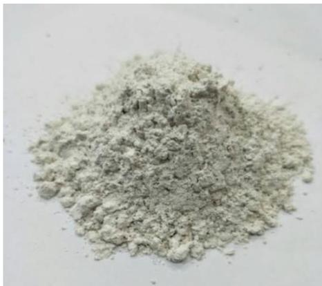
Gambar 12. Kalsium Hidroksida ( $\text{Ca}(\text{OH})_2$ ). (Sumber: DokumentasiSendiri)
