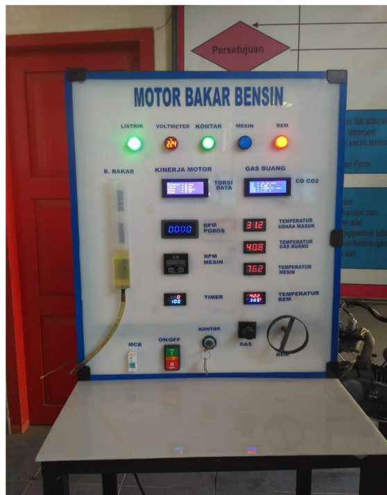
Gambar 5. Panel indikator dynamometer dan uji emisi gas buang
