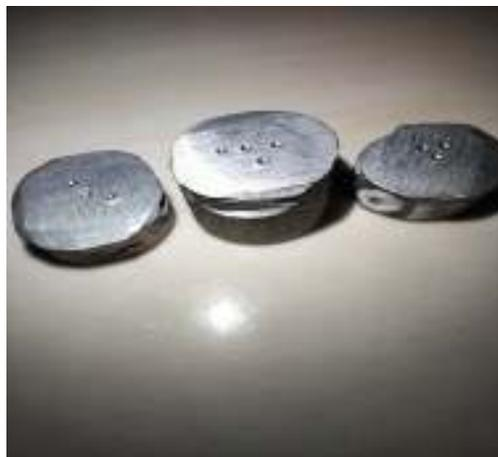
Gambar 34. Spesimen Pengujian Kekerasan Rockwell
