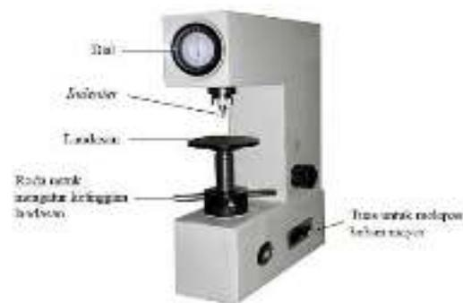
Gambar 30. Alat Uji Kekerasan Starret
