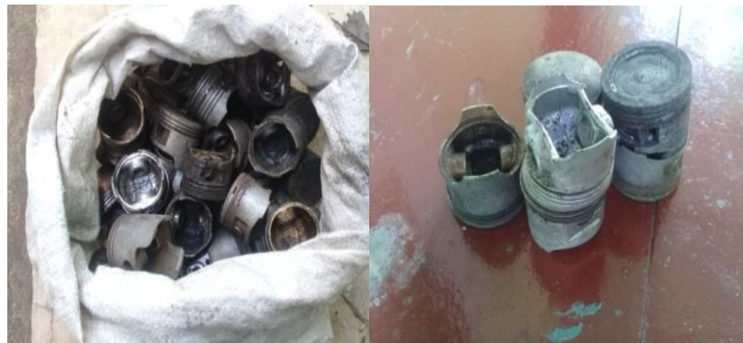
Gambar 20. aluminium scrap piston bekas ( dokumentasi sendiri )
