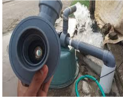
Gambar : 3.3 Rumah Pompa ( Sumber : central pompa.com )
