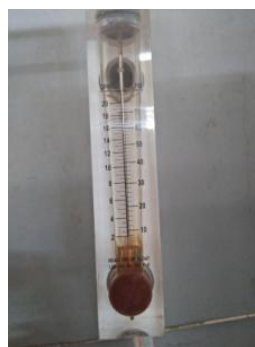
Gambar 3.7 Flow Meter (Sumber: Dokumentasi Sendiri)
