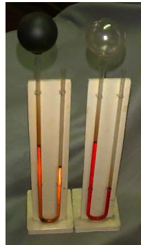
Gambar 3.8 Manometer -U (Sumber: Dokumentasi Sendiri)
