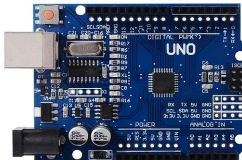
Gambar 3.6 Mikrokontrol arduino
