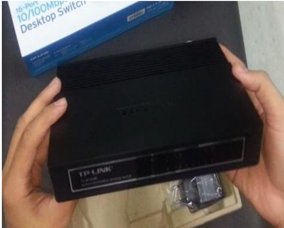
Gambar 33. Switch 16 port Tp-Link TL-SF1016DS(Sumber: penulis, 2021)
