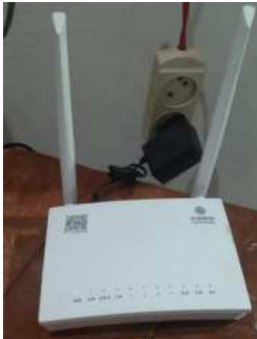
Gambar 35. Modem tipe GPON GM220-s (Sumber: Penulis, 2023)
