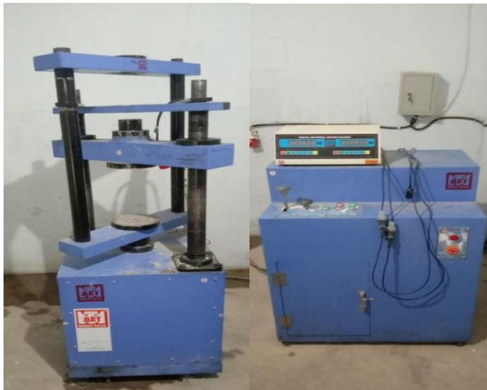
Gambar 18. Alat Uji Kuat Tekan Paving Block (Sumber: Laboratorium Teknik Sipil Universitas Muhammadiyah Metro, 2022)
