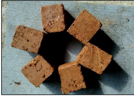
Gambar 17. Sampel Benda Uji Paving Block Berbentuk Kubus (Sumber: Taufiq Hanafi, 2022).
