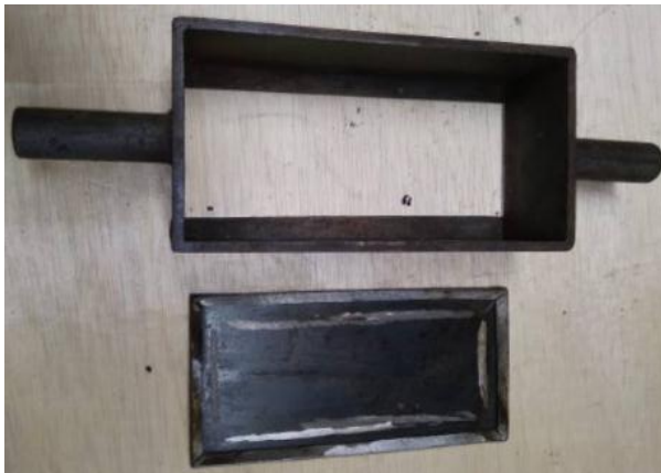
Gambar 16. Cetakan Paving Block (Sumber: Taufiq Hanafi, 2022)
