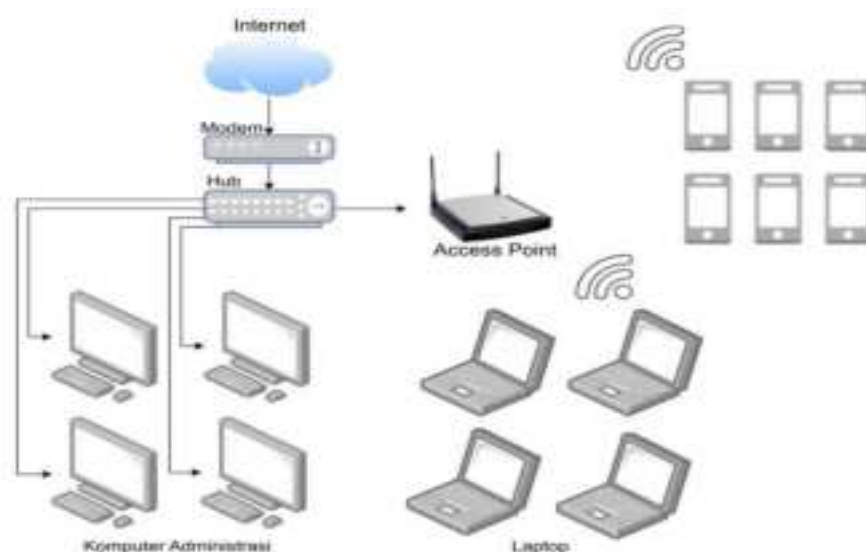
Gambar 33. Topologi Jaringan Wireless (Sumber : Penulis, 2023)
