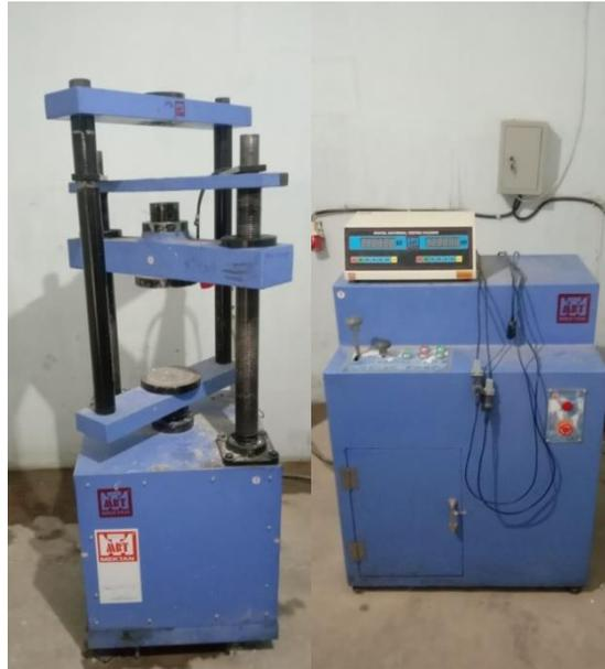
Gambar 17. Alat Uji Kuat Tekan Paving Block
