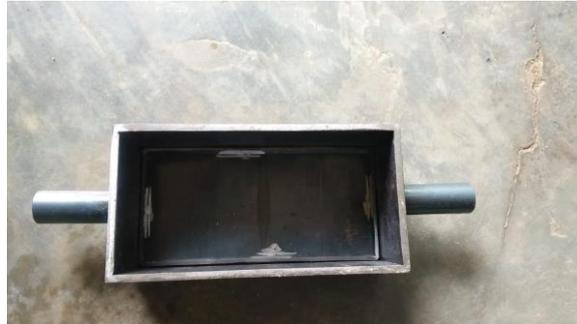
Gambar 15. Cetakan Paving Block
