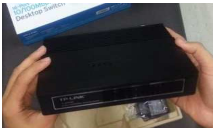
Gambar 13. Switch 16 port Tp-Link TL-SF1016DS (Sumber: penulis 2024).
