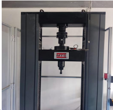
Gambar 5. Mesin uji tekan Universal Testing Machine (Sumber: Dokumen Pribadi, 2022)
