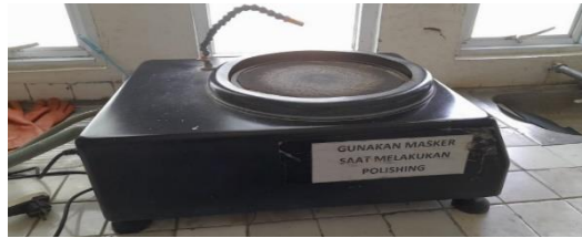
Gambar 17 Polishing Unipol 1210 Sumber: Dokumen Pribadi
