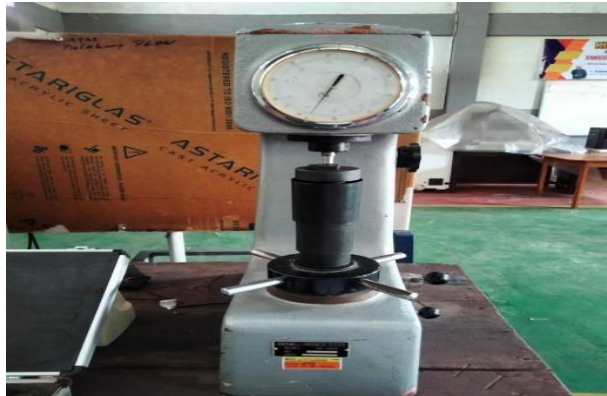
Gambar 16 Rockwall Hardness Tester (Sumber: Dokumen Pribadi)
