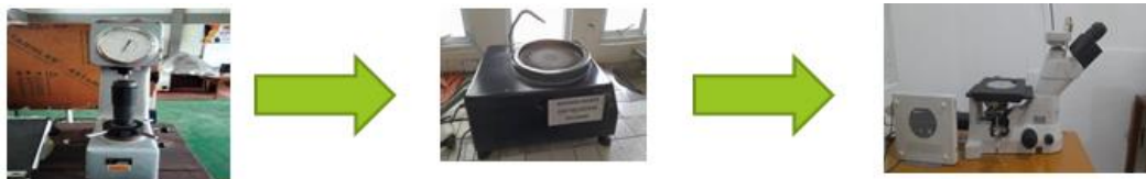
Gambar 25 Proses pengujian kekerasan dan difusi (Sumber: Dokumen pribadi)
