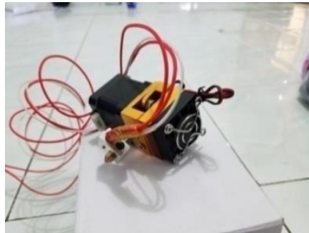
Gambar 44. Extruder , nozzle , dan temperature sensor (Sumber: Dokumentasi Pribadi)
