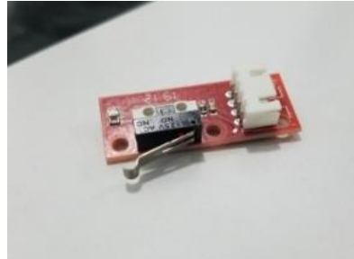
Gambar 49. Limit switch / endstop (Sumber: Dokumentasi Pribadi)
