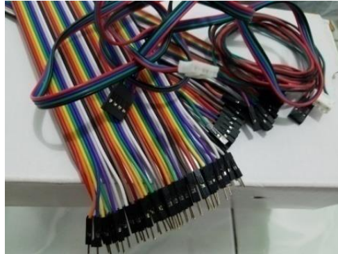
Gambar 52. Kabel jumper (Sumber: Dokumentasi Pribadi)
