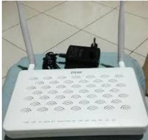
Gambar 42. Modem Zte F609 Ont Gpon (Sumber: Penulis, 2021)
