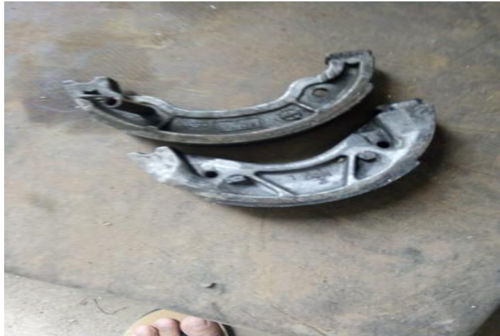
Gambar 27. Sepatu rem sepeda motor bekas (sumber : bengkel rudy)
